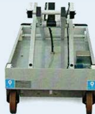
Geschlossenes Chassis für einfache Reinigung
